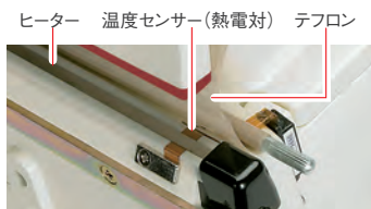
写真はテフロンなどの部品をはずし、温度センサー（熱電対）が見える状態で撮影したものです。
