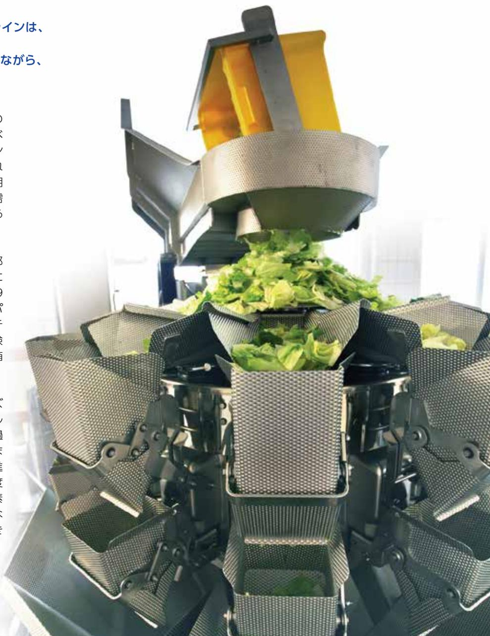
新しいラインでは、以前に計量と梱包に多くの労力を要していた作業が効率化されました。10ヘッドを備えるイシダRSシリーズ計量機のステンレススチールの接触面と高度な振動システムは、野菜が固まって詰まる可能性を減らします。分配システムは、フィーダーチューブとディッピングファンネルによって野菜をトレーの内側に丁寧に詰め、きれいに小分けすることで、手作業で密封の問題を見つける手間が大きく省けます。
