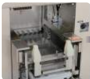
計量部/リフトヘッド取外し後
