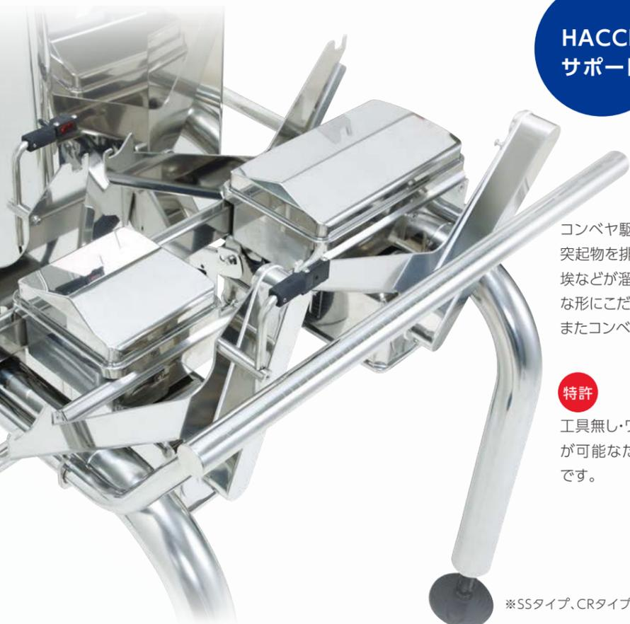
コンベヤ駆動部のミッドシップレイアウトに加え、ねじなどの突起物を排除し、丸パイプ脚を採用。雑菌の繁殖のもととなる埃などが溜まらず、菌の繁殖を防ぎ、清掃がしやすいシンプルな形にこだわりました。
