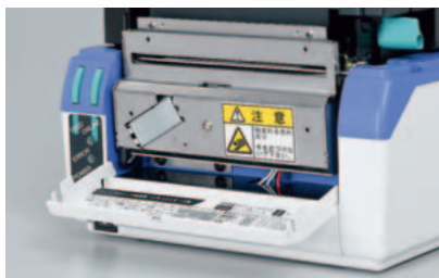
カッターユニット
