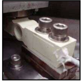
SUS製ロードセル 使用開始後3ヶ月 使用開始後12ヶ月 耐温水抗菌ウレタン塗装 使用開始後36ヶ月
